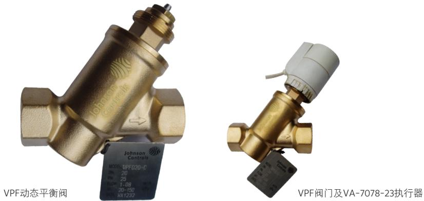
动态平衡电动二通阀主要被应用于空调系统中的风机盘管部分，既能根据室温开关进入风机盘管的水量，又能动态平衡水系统。
