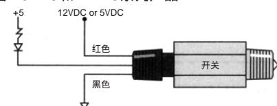
TTL 兼容输出—5VDC和12VDC系列产品
