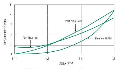
设备测试时位置垂直（导线向上），采用温度为+70°F(21°C)的水。
