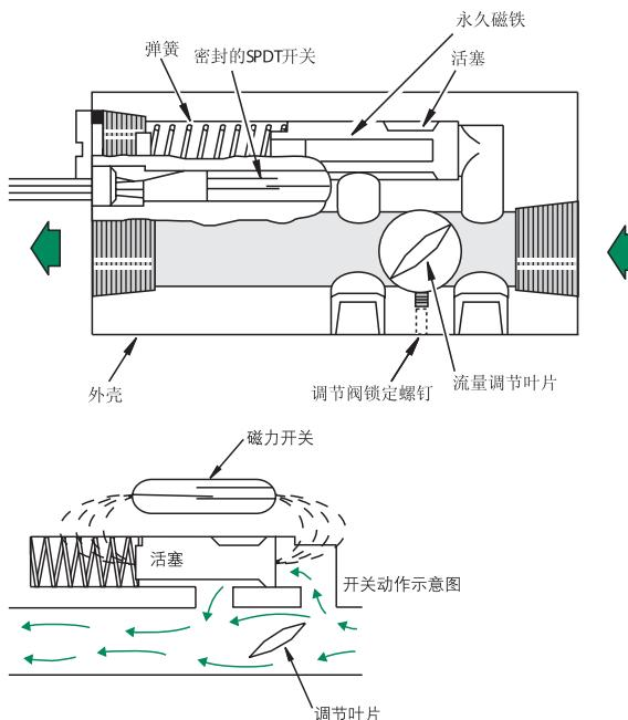
在设备内部的主要流量通道上，有一外部可调的叶片。带有磁铁的活塞位于支路流量室中。调节叶片周围流量所引起的压力差，会使带有弹簧的活塞移位，从而使密封的 SPDT 簧片开关产生动作。
