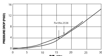
设备测试时位置水平，采用温度为 +70°F(21°C) 的水。
