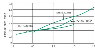
测试时将设备垂直放置 ( 导线向上 ), 水温+70°F ( 21°C )
