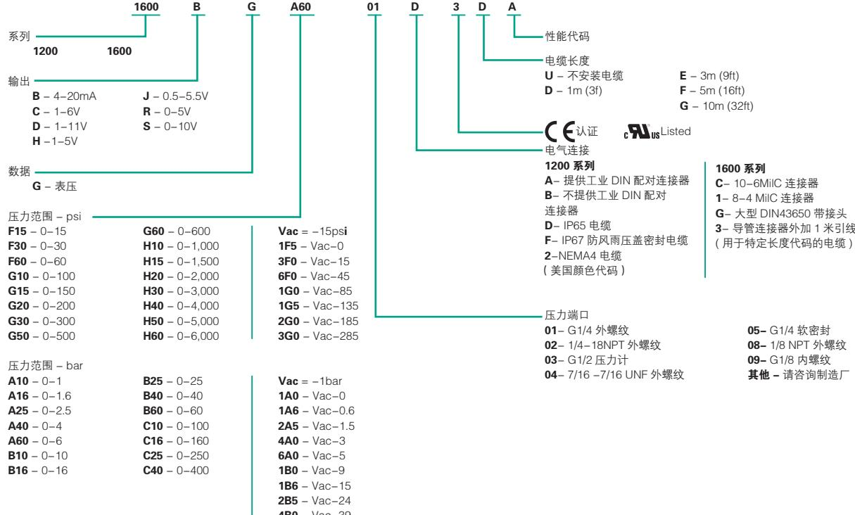
说明：1、当选定电缆连接时，客户必须从表 1 中选择电缆长度。当电气连接方式为“DIN”或插头式，须指明为“U”。
